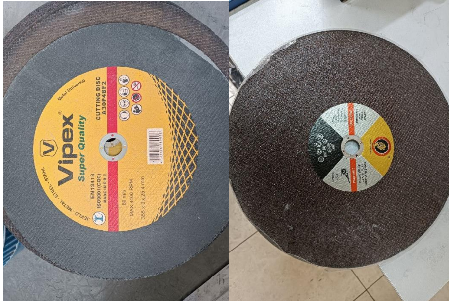
صفحه مخصوص دستگاه برش ریل
