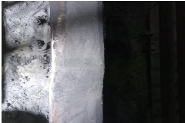
عکس نقطه دارای فرورفتگی بعد از جوشکاری و سنگ زنی
