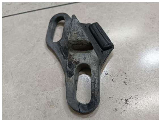
نمونه عکس از بین رفتگی قسمت لاستیکی رویه کلمپ
