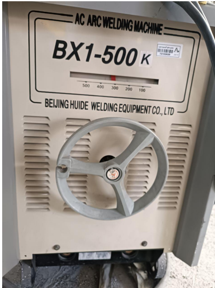
ترانس جوش مخصوص جوشکاری در میدان مغناطیس قوی
