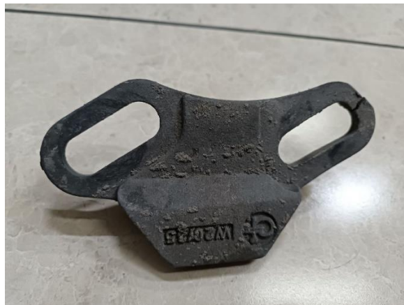
عکس نمونه کلمپ شکسته
