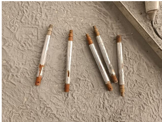
شفت استیل جهت قرار دادن زیر ریل برای جابجایی بهتر
