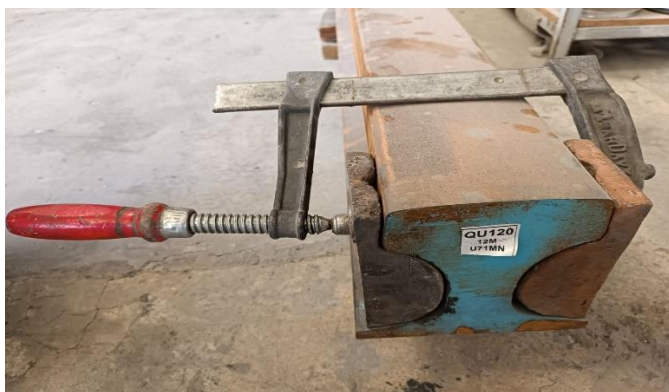
نحوه بستن قالب های مسی روی ریل
