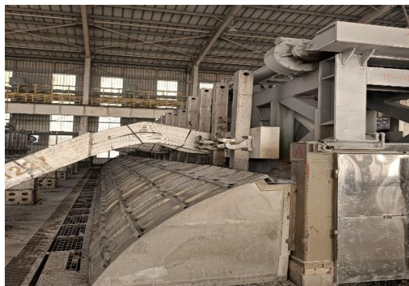
بسته بودن درب های سلول در حین عملیات جوشکاری ریل سالن احیا
