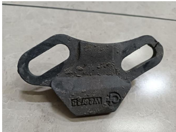
عکس نمونه کلمپ شکسته
